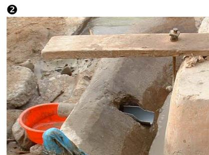
La utilización de la canaleta en la preconcentración de oro y la posterior amalgamación del concentrado abre la posibilidad para los mineros artesanales de procesar minerales con bajas leyes, que en el quimbaleteo tradicional no hubieran sido económicamente procesables. Eso se debe a la relativamente alta tasa de producción posible en la operación con canaleta. Utilizando
